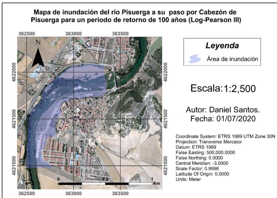
Figura 59. Mapa de inundación del río Pisuerga a su paso por Cabezón de Pisuerga para un periodo de retorno de 100 años (Log-Pearson III). Coordenadas UTM: 30T 4621547 363129.
