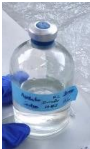
Figura 85. Bote pequeño donde se realizan los cultivos, sellado con septum de butilo.
