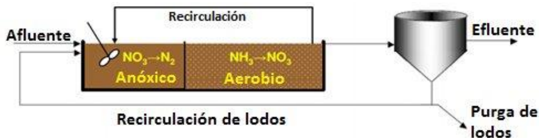
Figura 79. Esquema del Proceso Modificado Ludzack Ettinger (Tomado de Rodríguez, 2016).
